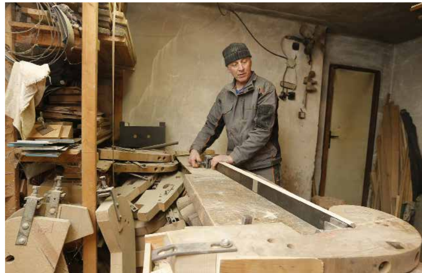
Saně se při kompletaci nelepí, spoje jsou čepované.
